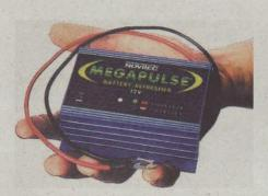
Helfer: Mit einem Pulser, hier das Gerät "Megapulse" von Novitec, lässt sich die Lebensdauer der Batterie verlängern.
