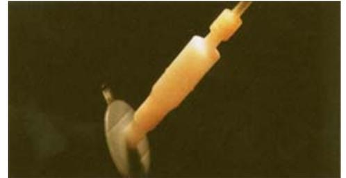
In Vakuumstellung und Druckstellung der Pumpe soll die entsprechende Stellung 5-10 Minuten stehen bleiben damit sich das Harz komplett verteilen und die Luft vollständig entweichen kann. Dieser Vorgang muß nicht überwacht werden, so daß noch Zeit für andere Dinge, welche am Fahrzeug erledigt werden müssen, bleibt.
