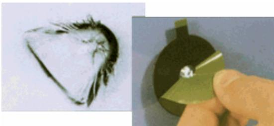
Clear-Star wendet von Beginn der Reparatur einfachere Methoden durch Anbringen eines Abdecksiegels auf der Reparaturstelle an. Das Abdecksiegel haftet direkt auf der Reparaturstelle und bildet somit einen luftdichten Reparaturbereich direkt über dem entstandenen Bruch, so daß die eingedrungene Luft abgepumpt werden kann.
