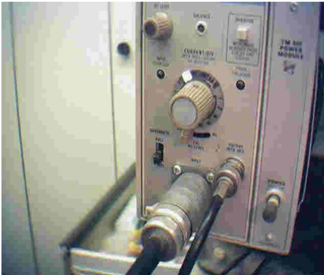
Bild 6 : Frontansicht des Elektronikteils der Stromzange Tektronix AM501
